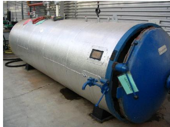
Uređaj za dezinfekciju supstrata (foto: Đ. Moravčević)
