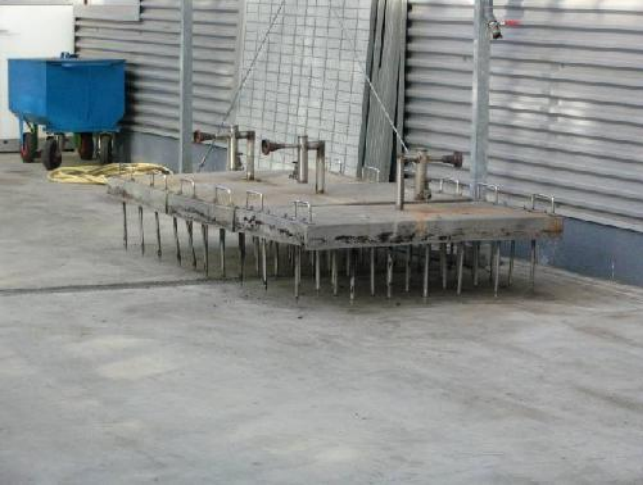
Uređaj za dezinfekciju zemljišta (foto: Đ. Moravčević)
