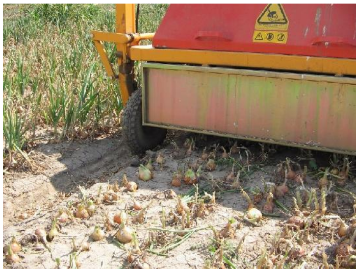
Mašina za odstranjivanje viška suve lisne mase (foto: Đ. Moravčević)
